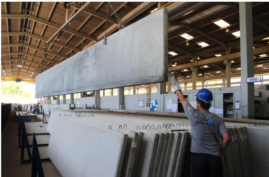
Os pré-fabricados em concreto são elementos produzidos em ambiente industrial, que depois são montados no canteiro de obras.
